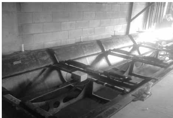
Figura 1. Colocación del acelerómetro triaxial Serie UP/CK/V1 (Umana Innova) en la trainera
